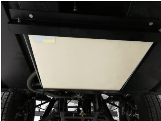
Widok zamontowanej cewki pod pojazdem
